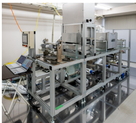
図2 RtoR レーザ乾燥試作機「WiDRY」
